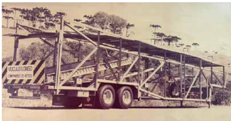
Dambroz 1982 e 1991: piso superior todo fixo e carros 4 e 5 com cilindro hidráulico
