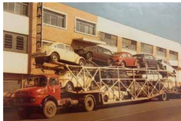
Dambroz 1982 e 1991: piso superior todo fixo e carros 4 e 5 com cilindro hidráulico
