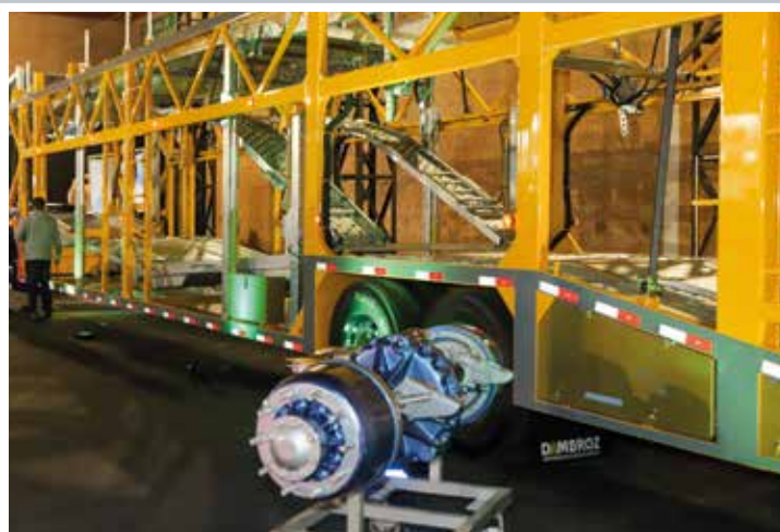
Cegonha Gran Versatille foi o destaque da Dambroz na Expo. Ao lado, o e-Sys, primeiro módulo de tração auxiliar com motor elétrico para carretas, da Suspensys, que pode equipar o implemento caso o cliente solicite
