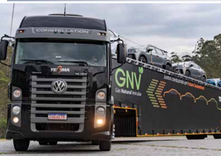
Projeto-piloto da Tagma permite que os veículos operem com 70% de queima a diesel e 30% de GNV
