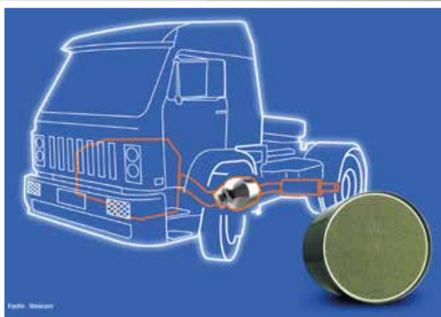
Catalisador é peça fundamental no sistema de exaustão, responsável por converter gases poluentes em substâncias menos nocivas
