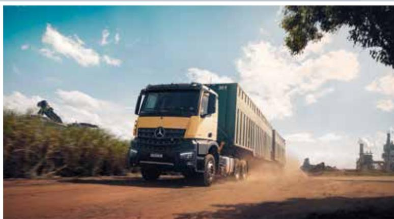
**Linha Arocs** – lançada em **2021**, trouxe inovação e muito mais robustez para as operações pesadas da mineração, construção civil e agronegócio. Inicialmente na versão 8x4, com até 58 toneladas de peso bruto total técnico, já em 2023 ganhou três novos modelos 6x4: 3351, 4151 e 3353, nas versões plataforma, basculante e cavalo mecânico.
