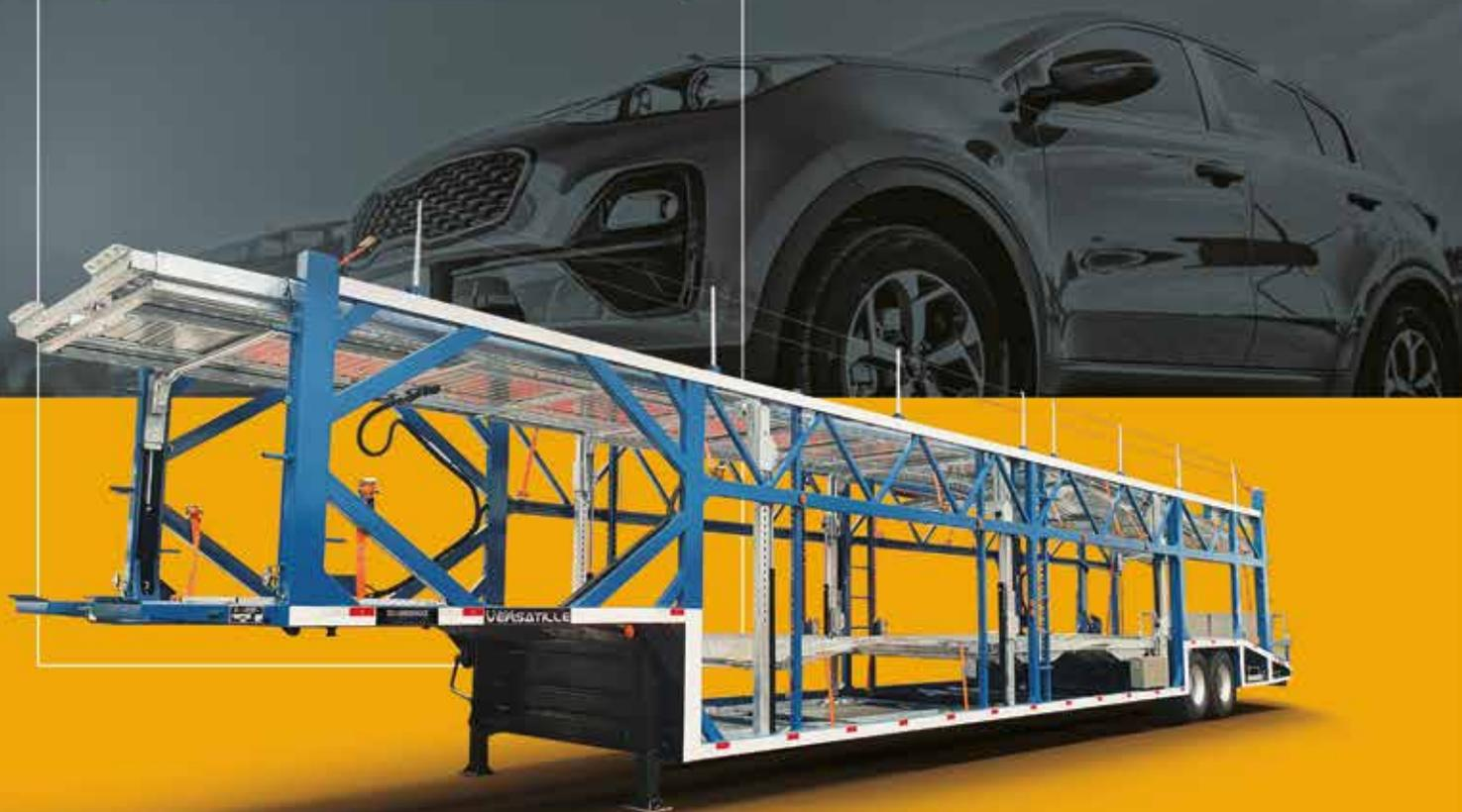
Com capacidade de até 11 veículos, a cegonha **GRAN VERSATILLE** é um dos melhores modelos disponíveis no mercado. Um implemento leve e resistente que possui alta durabilidade. Com tratamento galvanizado, pintura em PU e piso entre trilhos, toda sua iluminação é em LED.
